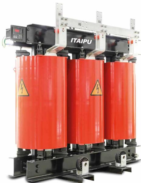
Os transformadores a seco são uma solução limpa, pois utilizam o ar como meio de isolamento e arrefecimento de seu circuito elétrico. Encapsulados em epóxi, possuem aplicação ideal para áreas com grande circulação de pessoas, pois sua resina é autoextinguível.
